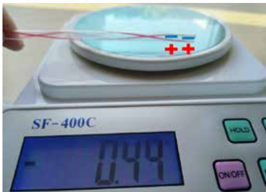
شکل ۴ نی نوشابهٔ باردار، سبب القای بارالکتریکی در کفهٔ فلزی ترازو می‌شود. نیروی جاذبهٔ بین بارهای الکتریکی، سبب می‌شود کفهٔ ترازو به بالا کشیده شود و مقداری منفی را نشان دهد.
